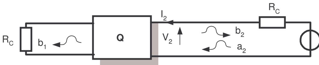
$S_{22} = \left. \frac{b_2}{a_2} \right|_{a_1=0}$  il s'agit donc du coefficient de réflexion à l'accès 2, l'accès 1 étant adaptée à la résistance de normalisation ( $Z_G=R_C$ , la présence d'une f.e.m. ne changeant rien).
