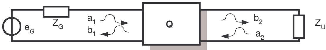
Le quadripôle est caractérisé par ses paramètres S, la charge par son coefficient de réflexion  $\rho_U$  et le générateur par son coefficient de réflexion  $\rho_G$  ainsi que son coefficient de transmission  $t_G$ . Ce dernier est le rapport de la tension de sortie aux bornes du générateur chargé par  $R_C$ , sur la tension de sortie du générateur chargé par  $R_C$  si l'impédance interne était  $R_C$ . Le terme  $a_G$  représente alors l'onde incidente dans ce dernier cas;
