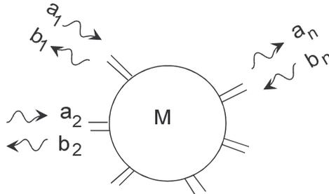
$$[b] = [S][a] \Leftrightarrow \begin{bmatrix} b_1 \\ \cdot \\ \cdot \\ \cdot \\ b_2 \end{bmatrix} = \begin{bmatrix} S_{11} & \dots & S_{1n} \\ \cdot & \dots & \cdot \\ \cdot & \dots & S_{ij} & \dots \\ \cdot & \dots & \cdot & \dots \\ S_{n1} & \dots & S_{nn} \end{bmatrix} \begin{bmatrix} a_1 \\ \cdot \\ \cdot \\ \cdot \\ a_2 \end{bmatrix}$$
