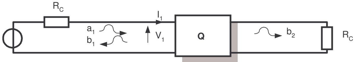
$S_{11} = \left. \frac{b_1}{a_1} \right|_{a_2=0}$  il s'agit donc du coefficient de réflexion à l'accès 1, l'accès 2 étant adaptée à la résistance de normalisation (charge  $Z_U=R_C$ ).
